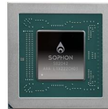
Серверный RISC-V процессор SG2042 – 64 hiperf ядер, 64МБ кэш памяти, 2 ГГц тактовая частота
